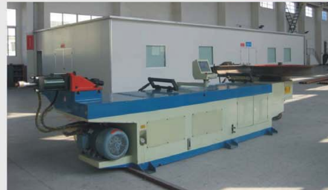
▼ 管材弯制设备 Pipe bending machines
